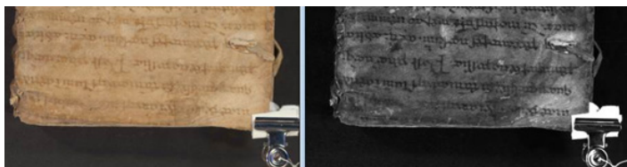
Slika 25 Donji dio prednje korice knjige signature A20911, prikaz abrazije pod vidljivom svjetlošću i UV svjetlošću u označenom području.
